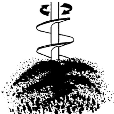
**SPINNING THE DIRT OFF THE AUGER**
